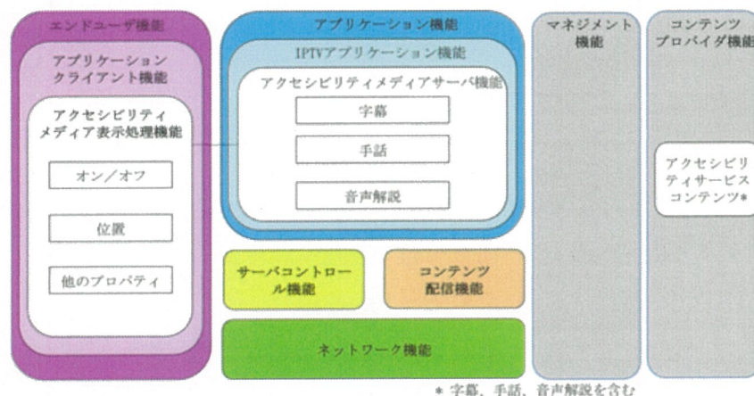
図1 アクセシビリティサービスを備えたIPTVの機能ブロック図
