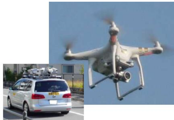
レーザ測量等+ドローンによる3次元測量
