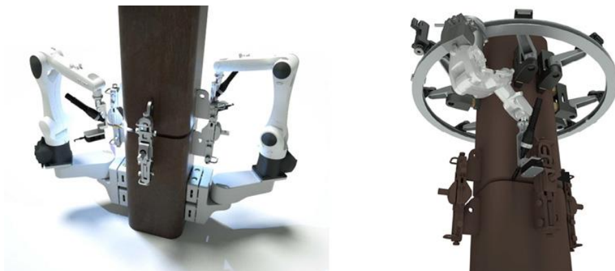
溶接ロボット
