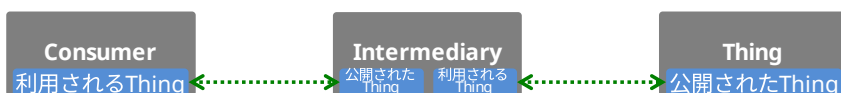
図31 プロキシとして機能するIntermediaryを介したConsumerとThingの接続
