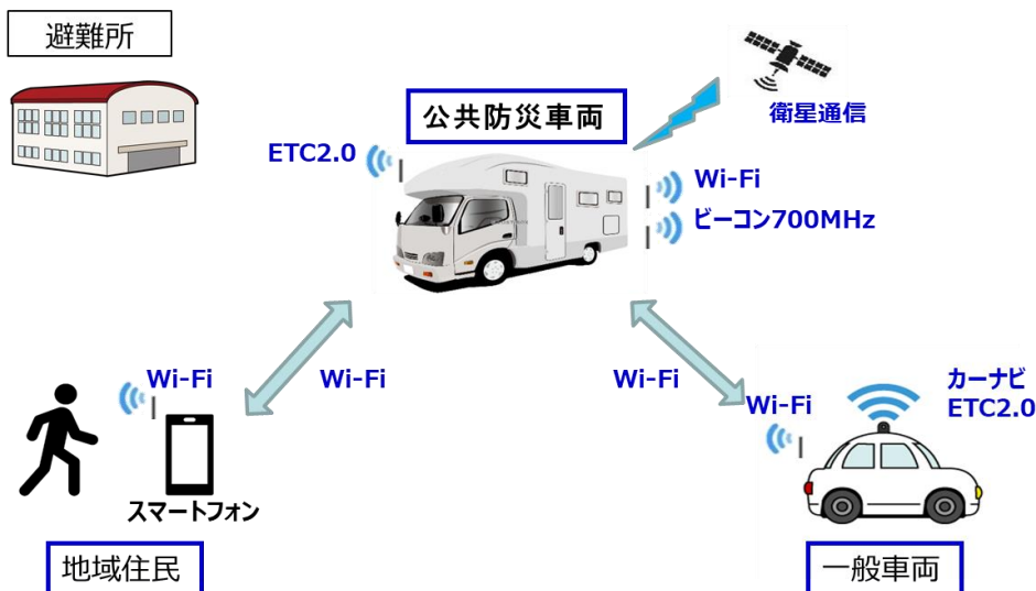
図 4-6 V-HUB 導入事例) 災害対策本部とのコミュニケーション① (衛星通信)
