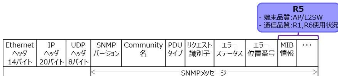
図 13 イーサネット&IP&一部 SNMP NA のフレーム例
