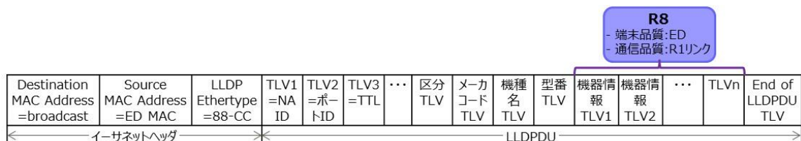
図 9 イーサネット&IP&HTIP ED のフレーム例
