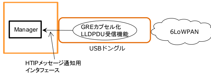
図2-7 ManagerがIP層以上も終端するUSB Dongleで非イーサネットデータリンク層と接続する場合の構成
