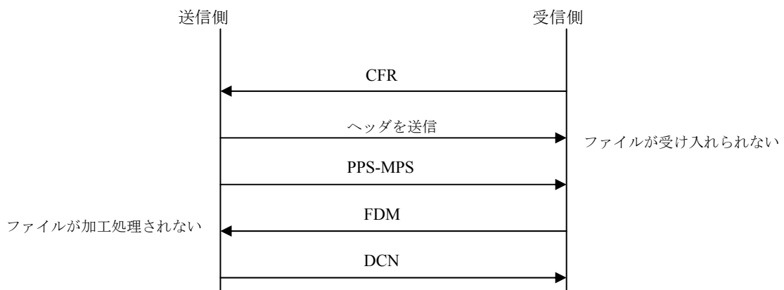
付図6-6 / JT-T30 送信ファイルが送信側で加工処理されない場合 (ITU-T T.30)
