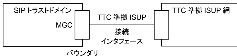
付図 h-1/JT-Q3401 SIP-TTC ISUP 相互接続モデル
