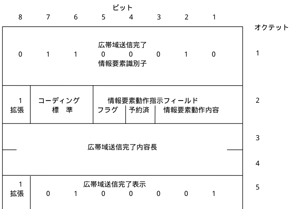
図4-27/JT-Q2931 広帯域送信完了情報要素 (ITU-T Q.2931)
