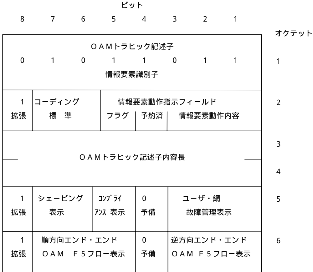
図4-30/JT-Q2931 OAMトラヒック記述子情報要素 (ITU-T Q.2931)
