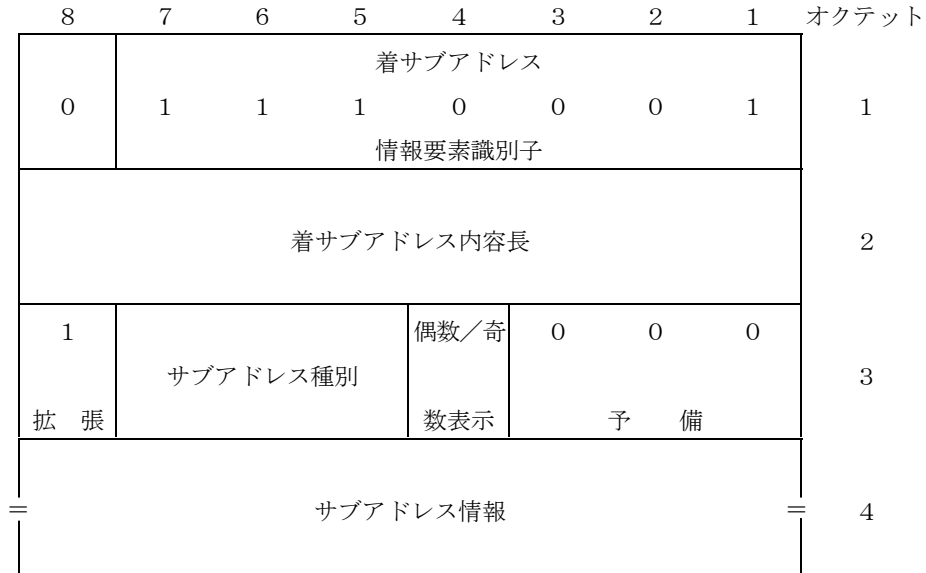
図 4-15/JT-Q931 着サブアドレス情報要素 (ITU-T Q.931)
