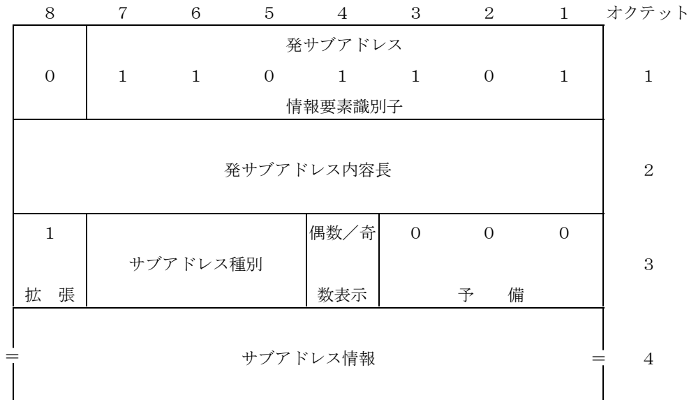
図 4-17/JT-Q931 発サブアドレス情報要素 (ITU-T Q.931)
