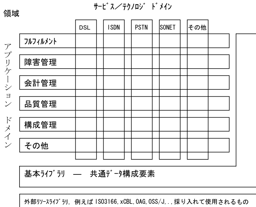
図 2 / JT-M3030 tML スキーマ構造 (ITU-T M.3030)
