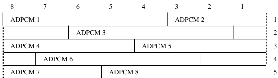
図E-1/JT-I366.2 TTC標準JT-G726-4.0符号化データユニットフォーマット (ITU-T I.366.2)
