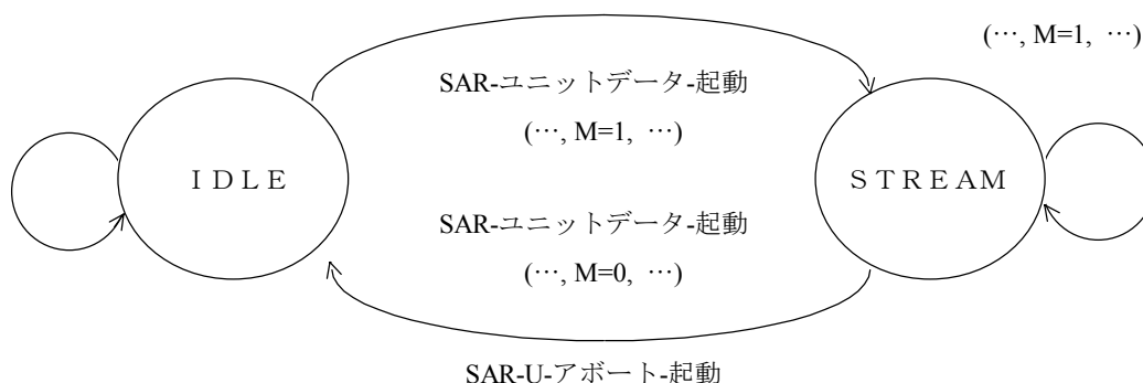
図8 / JT-I 363. 3 SAR送信部における状態遷移図 (ITU-T I363.3)
