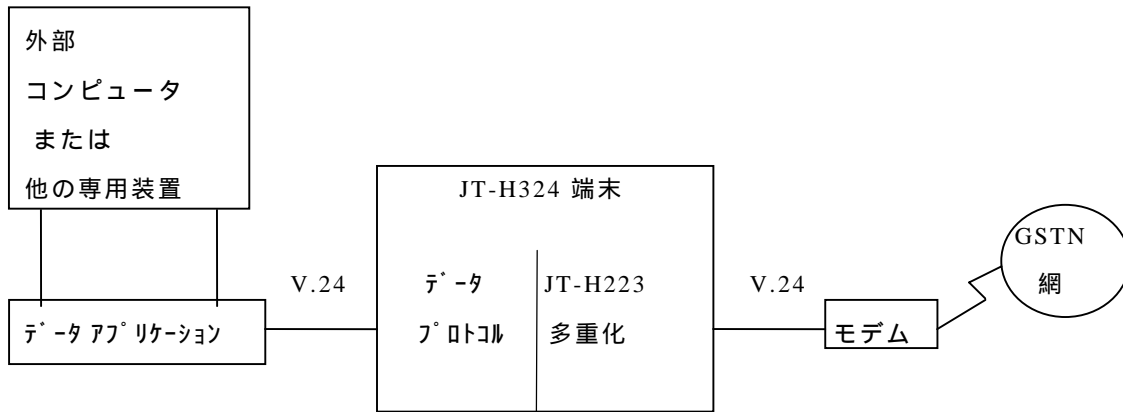
図2/JT-H324 データアプリケーション - データプロトコル インタフェース (ITU-T H.324)
