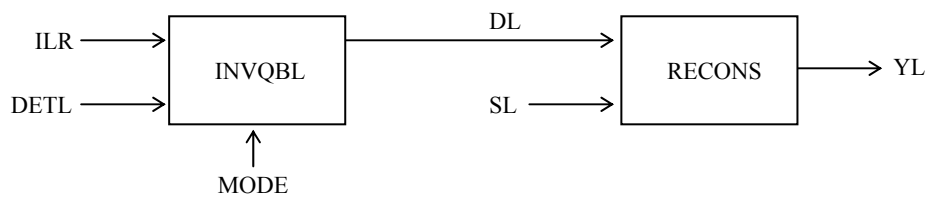
図 6-6 / J T - G 7 2 2 低域における復号器出力のための再生信号算出器 (ITU-T G.722)
